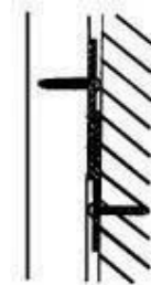
Décor Panel attachment with clips.
